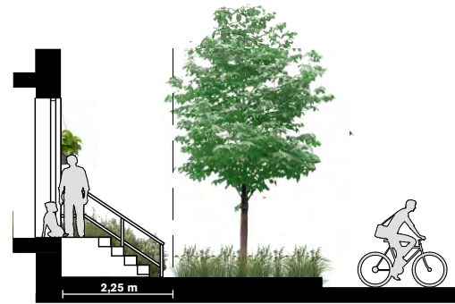
Typ C Denna uppbyggnad av frizon har en avsats vid dörren för att därefter leda ner till en yta i markplan. Typ C behöver räcken på kortändarna.
