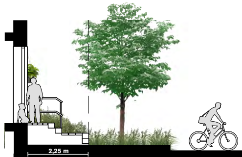
Typ B Denna uppbyggnad av frizon har en avsats vid dörren för att därefter med två steg leda ner till en terrassdel. Terrassdelen möter gatans grönzon med ett högre "sittsteg". Typ B behöver endast ha räcken på kortändarna.
