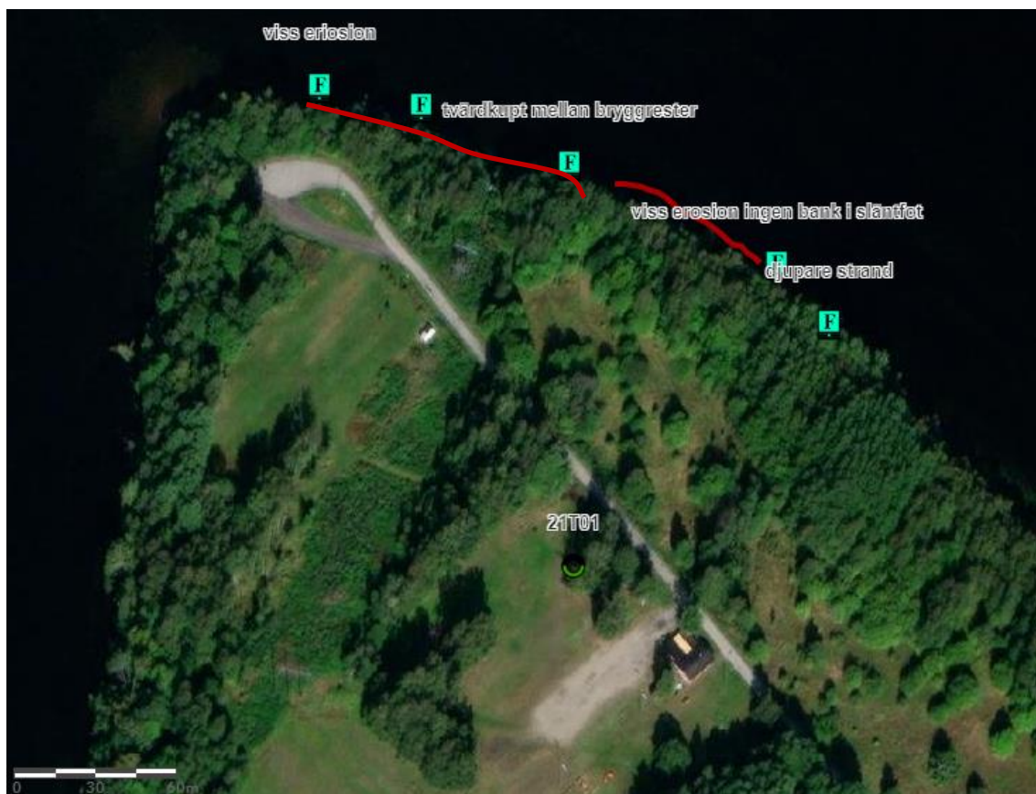
Figur 7. Röd linje markerar sträcka där viss erosion observerats
