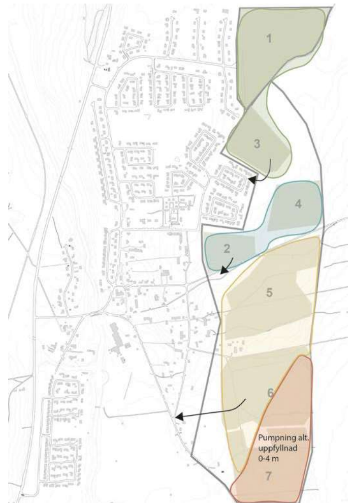
Karta visar vart nya delområden kan anslutas till befintligt system för vatten och spillvatten.
