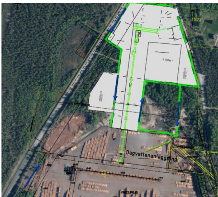
Figur 2. Översikt av planerad utökning av verksamhetsområdet. Allt dagvatten från området leds till planerad dagvattenanläggning.
