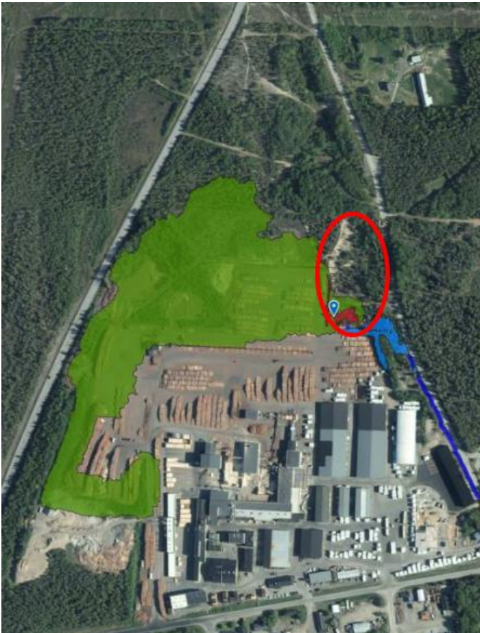
Figur 3. Befintligt område som planeras avledas mot framtida dagvattenanläggning markerat i grönt. Röd ellips markerar placering av framtida dagvattenanläggning.
