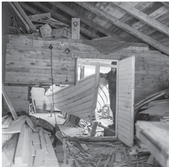
Båten ska nu tas ut från Holgers verkstad. En del av väggen tas bort för att båten ska kunna passera. Sedan byggs väggen hel igen, i väntan på nästa båtbygge.
