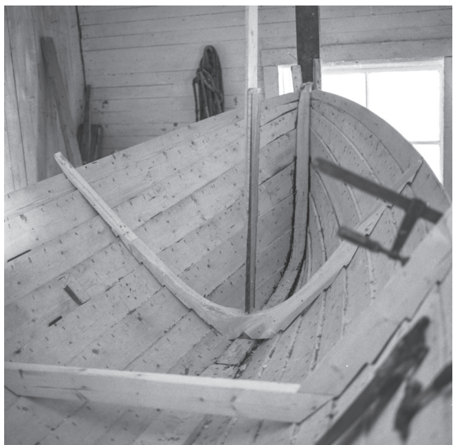
Inredet påbörjas. Första roten är insatt, ursprungligen en granrot med vidsittande stam. I förgrunden syns en av båtens tre tvärbalkar, bett.
