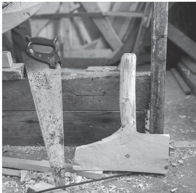
Ämnet till en årtull, hå, hämtas från en tall med lämpligt grov grenklyka.
