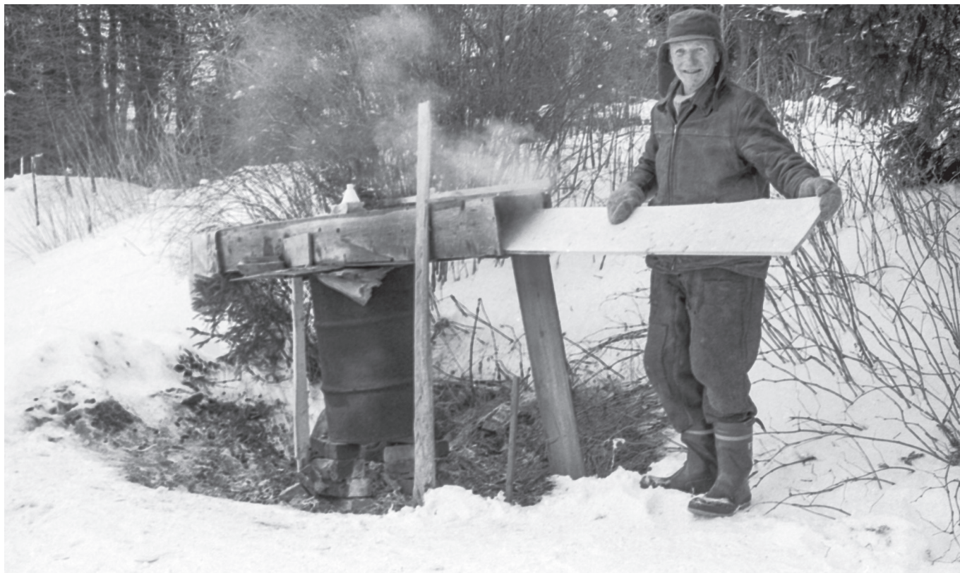
Båtbrädorna, borden, basas. Holger eldar under en tunna fylld med vatten. Ångan som bildas går upp i en avlång låda där borden förs in. Genomvarma blir de möjliga att böja till rätt form.
