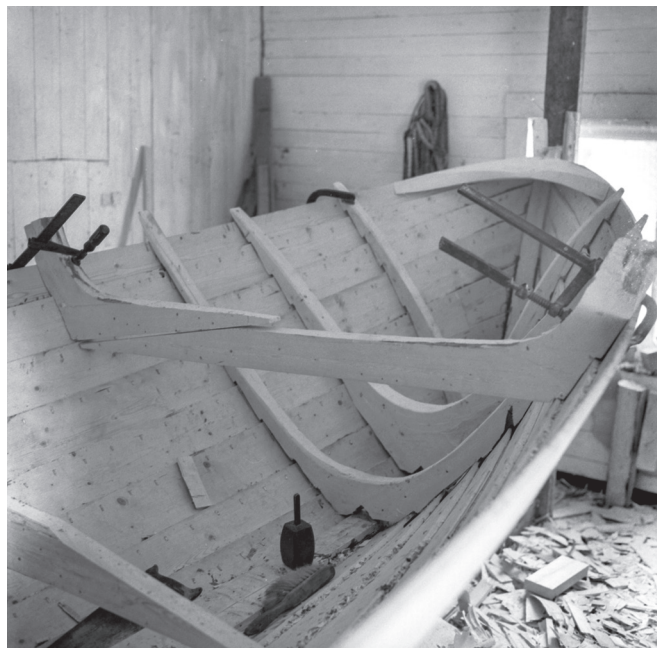
Längst fram i båten sätts en så kallad knaftrot. Ännu ett bett förbereds för montering.
