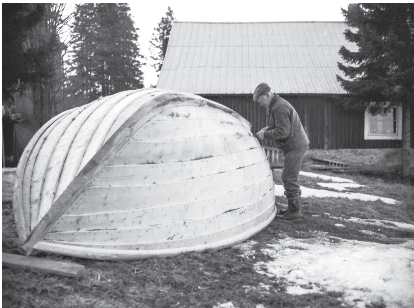
När båten förts ut vänds den upp och ner. Nu sätts draget fast. Det består av en smal senvuxen gran eller en järnskena som ska skydda kölen från slitage. Sedan passar det bra att stryka tjära på utsidan.
