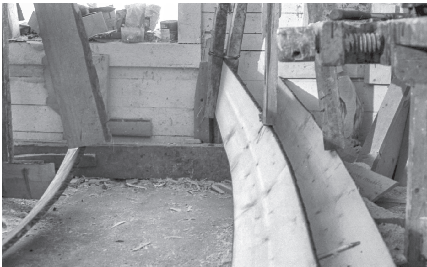
Båtborden sätts i spänn för att behålla sin form när de svalnar.
