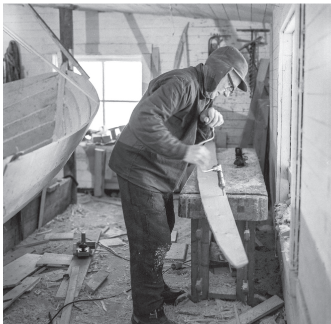
Innan båtboarden sätts på plats förborrar Holger alla hål där spikarna ska slås in och sedan nådas, böjas tillbaka.
