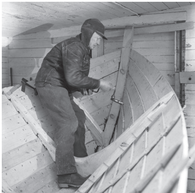
Holger förborrar för att kunna sätta in sista roten i aktern. Han har även satt i några vränger. De formas ur senvuxna myrgranar och kan sägas vara båtens "revben".
