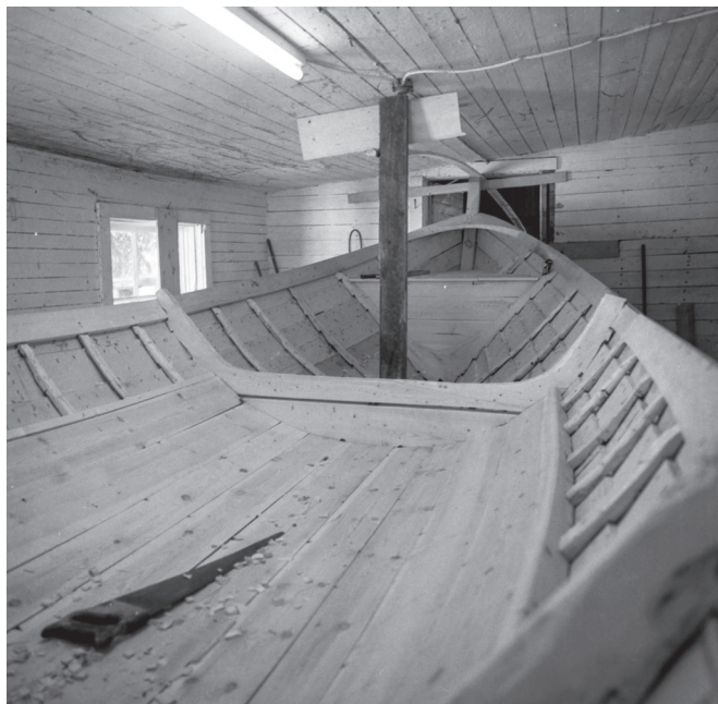
Båtens lastutrymme, bunken, har ett golv som kallas farved. Bunken avslutas upptill av sudstockar som hindrar småfisk och annat löst att glida ner bakom farveden.
