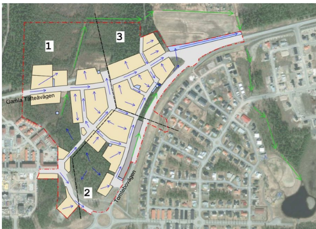
Bild 34: Rekommenderade rinnvägar som behöver säkerställas. Siffrorna anger planens utbyggningsetapper. Gröna pilar illustrerar befintliga diken och blåa pilar illustrerar nya rinnvägar. Urklipp från WSP dagvattenutredning maj 2019.
