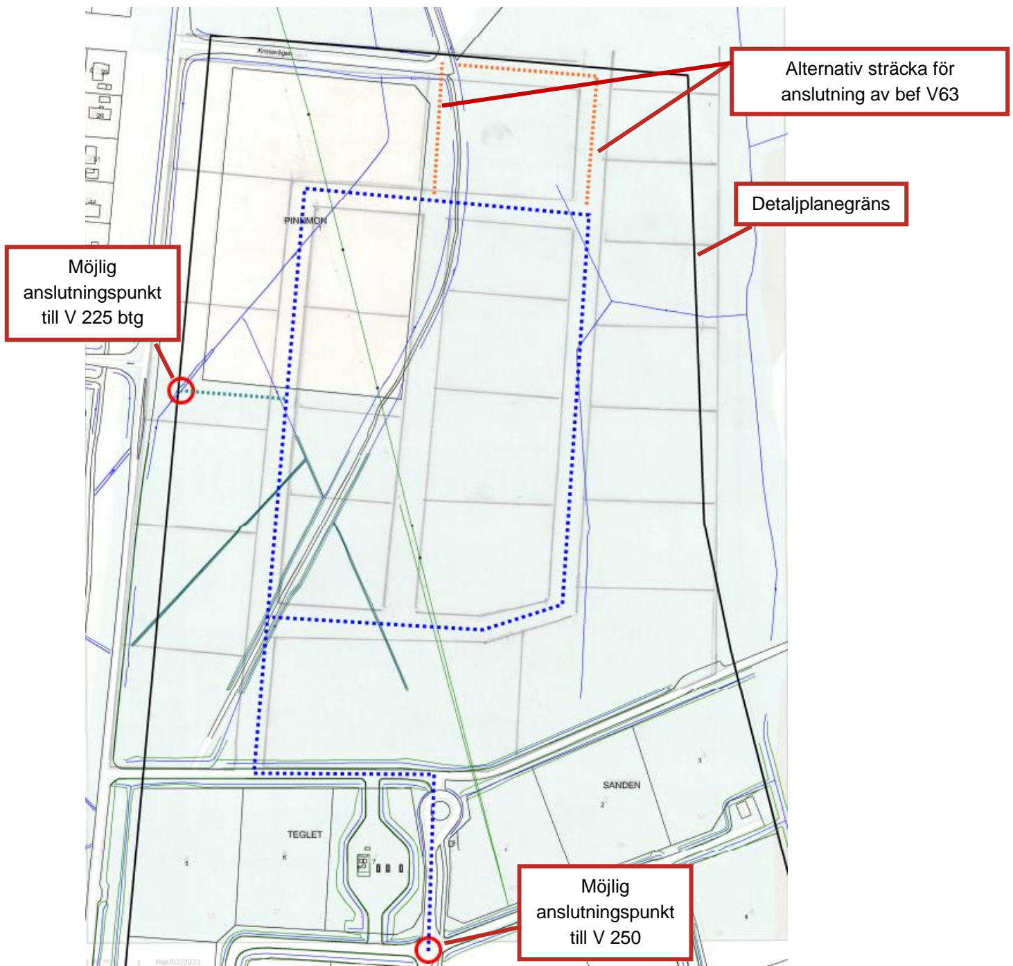
Figur 36. Föreslagen ledningsdragning för dricksvattenledningar inom utredningsområdet.
