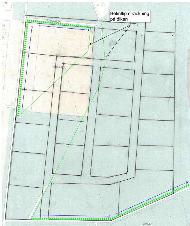
Figur 32. Omläddning av befintliga diken.
