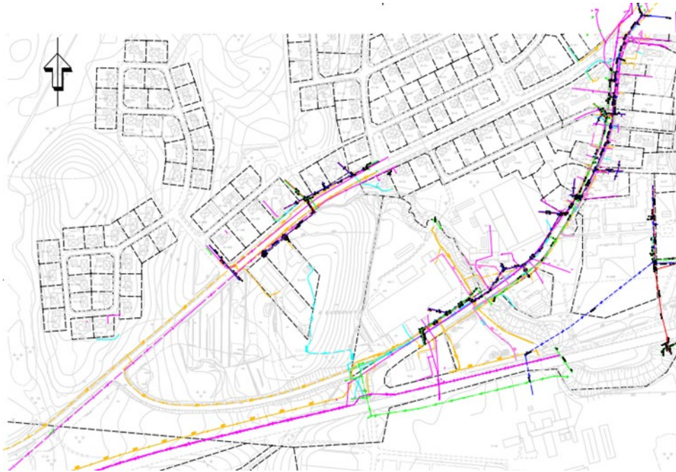
Befintliga ledningar vid Kungsvägen i Sävar (Källa: WSP).
