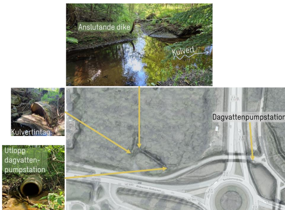
Figur 8. Översikt lokalisering av befintlig dagvattenpumpstation med utlopp och dike som ansluter till Kolbäcken.
