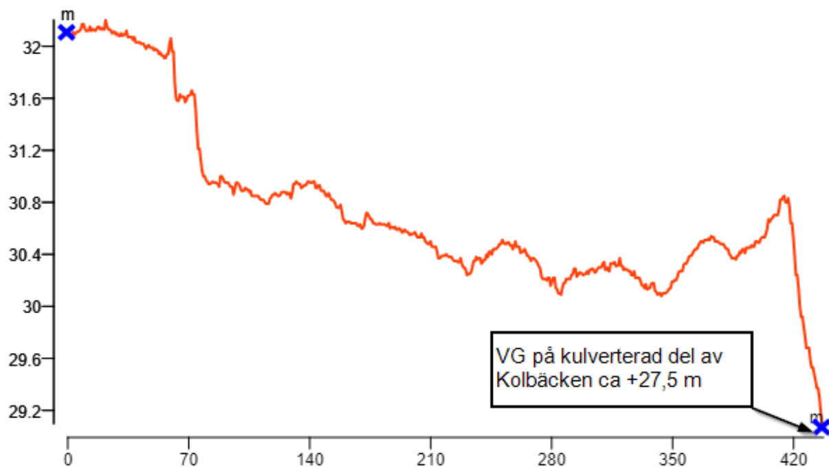
Figur 19. Profil över befintlig mark längs föreslagen ledningsdragning från område H och G till kulverterade Kolbäcken i figur 18 (Scalco Live, 2023).
