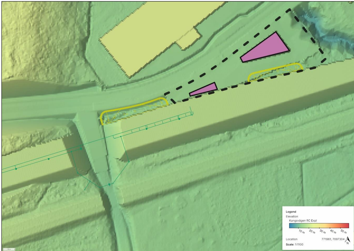
Figur 18. Planerad framtida avvattning av perrong (gröna linjer) och släntytor med plantering (gula linjer)
