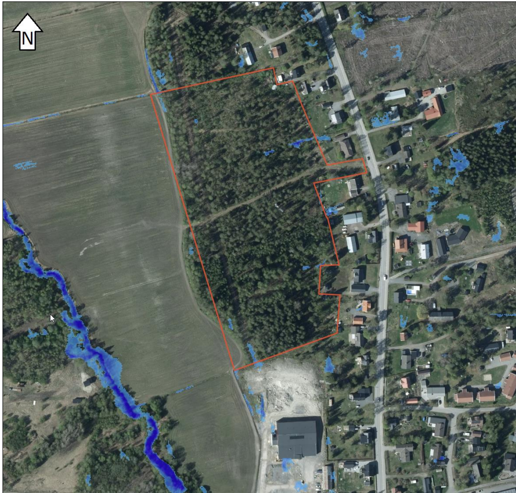
Figur 9. Lågpunkter/instängda områden illustreras i blått, utredningsrådet inom röd markering. Lågpunkter för hela Stöcke redovisas i bilaga 2 och 3.
