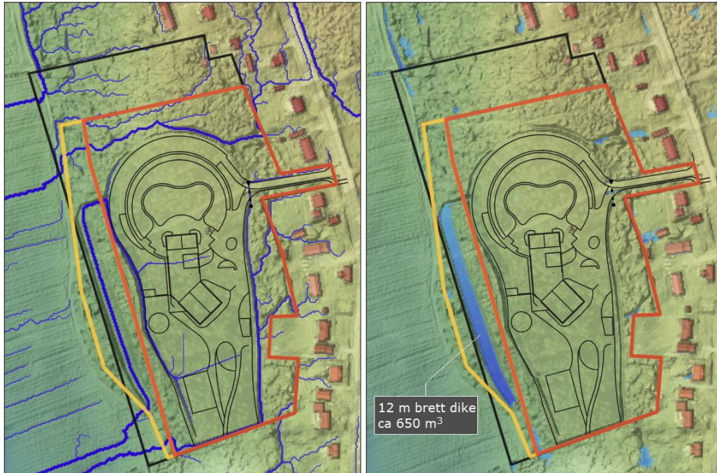
Figur 17. Skyfallsanalys efter exploatering för att omhänderta minst 600 m³ . Figur till vänster illustrerar rinnvägar och figur till höger lågpunkter/instängda områden med föreslagen höjdsättning. Svart linje – Utredningsområde, Röd linje – skolorråde och gul linje – natur.
