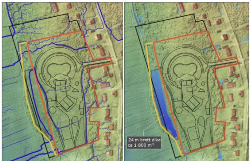
Figur 8. Skyfallsanalys visandes ytbehov för att omhänderta skyfall med en volym på minst 1 800 m 3 , beräknat utifrån ett maxscenario med ett 100-årsregn om hela utredningsområdet (svart område) planläggs för skoländamål. I dagsläget är det enbart rödmarkerat område som planläggs för skoländamål). AFRY, 2024-10-17
