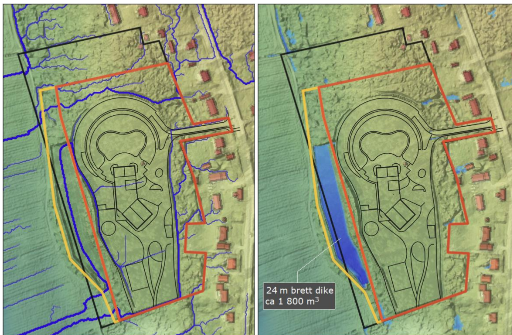
Figur 18. Skyfallsanalys efter exploatering för att omhänderta minst 1 800 m³ . Figur till vänster illustrerar rinnvägar och figur till höger lågpunkter/instängda områden med föreslagen höjdsättning. Svart linje – Utredningsområde, Röd linje – skolorråde och gul linje – natur.
