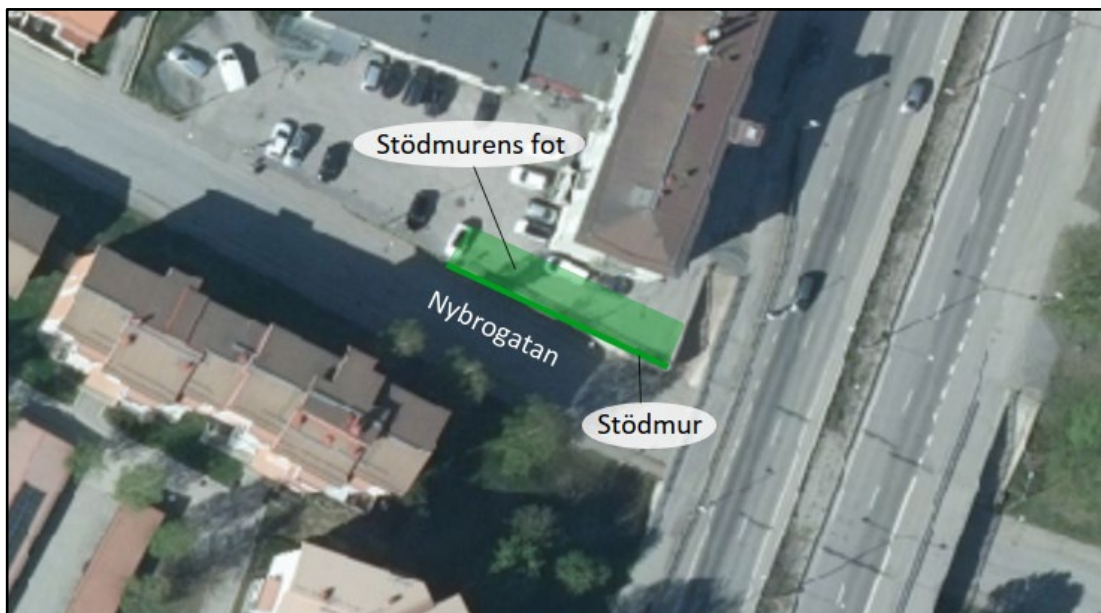
Figur 23. Placering av stödmur och utbredning av stödmurens konstruktion vid fastighetsgräns mot Nybrogatan.
