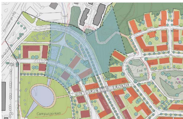
Figur 5-3. Kartan redovisar område där särskild hänsyn ska tas till dagvattenhantering för att säkerställa att dagvatten tas om hand inom området utan att belasta Sandbäcken. Även bebyggelse möjliggörs inom detta dagvattenreservat under förutsättning att dagvattenhantering klaras för föreslagen exploatering.
