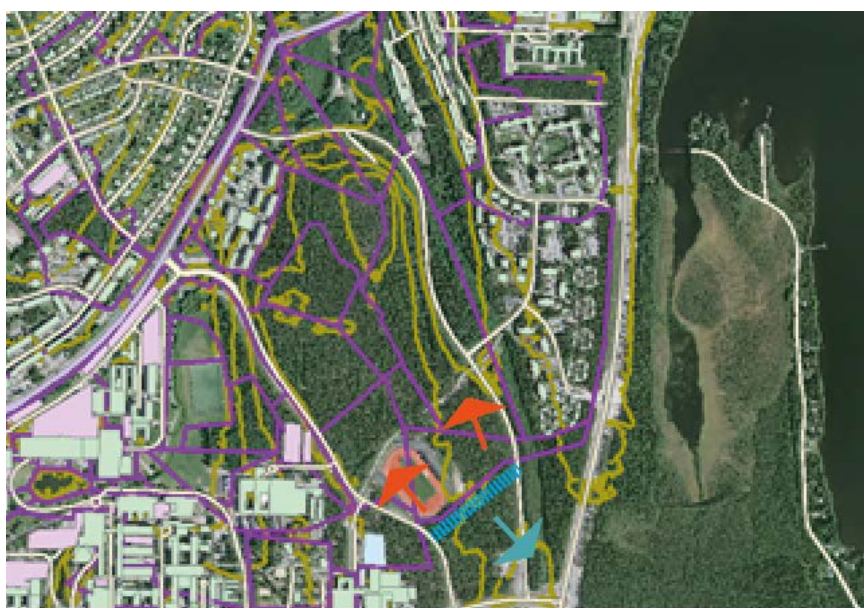
Figur 5-2. Karta visar vattendelare och avrinning inom området. Riktningarna på vattenflöden går åt olika håll söder om arenan. Det som rinner mot norr går till Sandbäcken och det som rinner mot söder till Kolbäcken.
