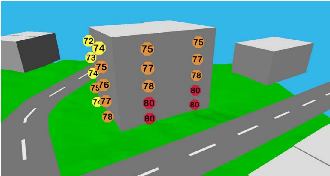
Figur 8. 3D-vy från syd över södra fasaden för maximal ljudnivå - L_{Amax} , dB.
