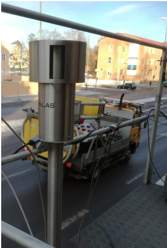
Intagshuvudet för luftintag till partikelmätaren vid Västra Esplanaden.
