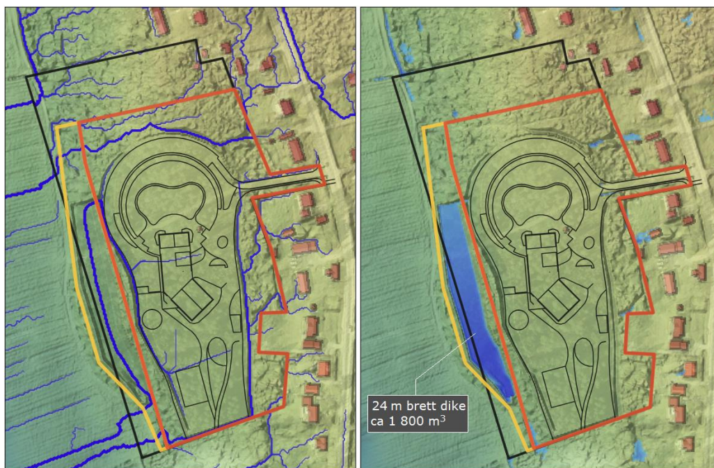
Figur 18. Skyfallsanalys efter exploatering för att omhänderta minst 1 800 m³ . Figur till vänster illustrerar rinnvägar och figur till höger lågpunkter/instängda områden med föreslagen höjdsättning. Svart linje – Utredningsområde, Röd linje – skolområde och gul linje – natur.
