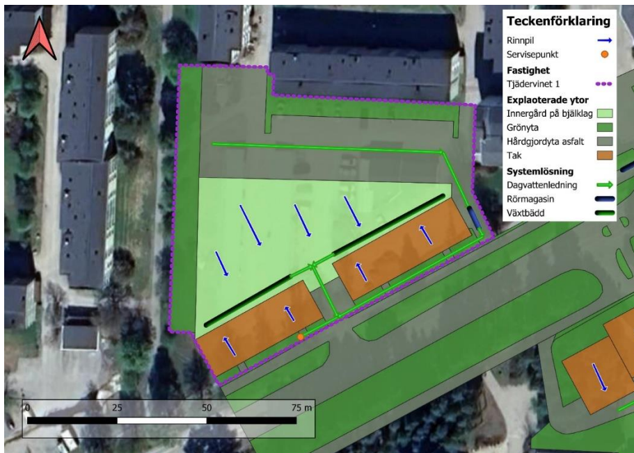
Figur 25. Systemlösning för dagvattenhantering inom del av fastigheten Tjädervinet 1.
