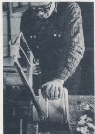
Överkanten sågas jämn efter den tidigare gjorda markeringen.
