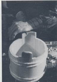
Örstavarnas överdel täljs jämn och hålen borras och täljs ur. Utskjutande delar av bandet putsas bort.
